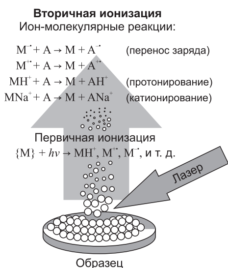
Рис. 1. Схематическое представление механизма MALDI.
